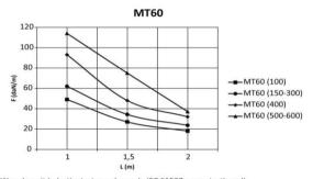
Waarden uit belastingtesten volgens de IEC 61537 norm, testtype II. Geen koppeling in 1ste en laatste overspanning, end-span = 0.8xL, MT60-JCL-PG
