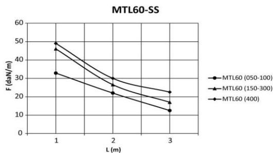
Werte aus Belastungsprüfungen nach der Norm IEC 61537, Prüftyp II.
