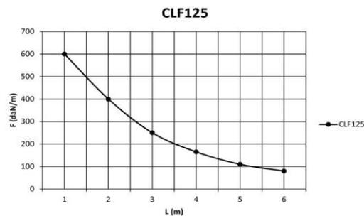
Werte aus Belastungsprüfungen nach der Norm IEC 61537, Prüftyp II.
