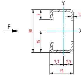
Flexion / charge max. calculée sur base de la contrainte de flexion admissible maximale
