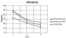
Werte aus Belastungsprüfungen nach der Norm IEC 61537, Prüftyp II. Keine Verbindung bei erster und letzter Überspannung, Endspannweite = 0.8xL, MT60-JCL-SS
